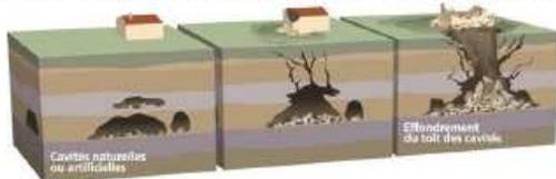
La décompression des roches est à l'origine de l'effondrement du toit des cavités souterraines.
